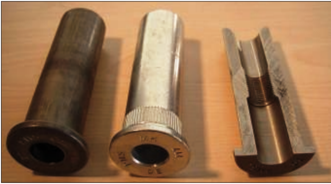
Bild 3 Achszapfen Pressrohling und Fertigteil
