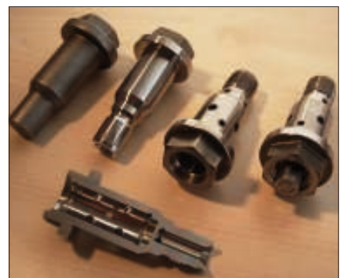
Bild 6 Ventilgehäuse Pressteil, Halb-, Fertigteil, Baugruppe
